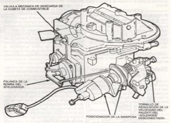
Carburador para motor 2150, con solenoide
