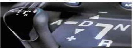
(EST). Questa trasmissione permette al guidatore di scegliere se selezionare le marce in modalità sequenziale oppure nella configurazione automatica.
